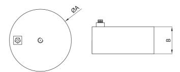
Die Haftkraft ist abhängig von der Stahlgüte, der Beschaffenheit der Kontaktfläche, der Materialdicke und der Kontaktfläche des Magneten.
